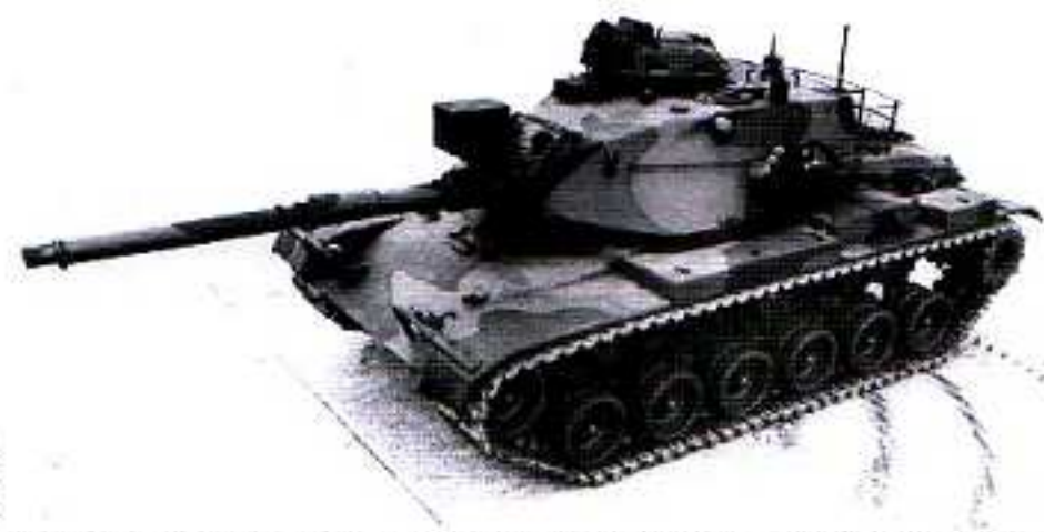
Ab 1986 erfolgte die Umrüstung des Bataillons auf den Kampfpanzer M-60A30. Aus Kostengründen wurde dabei aber vorerst auf die Anschaffung eines Wärmebildgerätes sowie auf eine Verbesserung der Motorleistung verzichtet.
