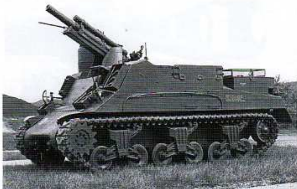
Ursprünglich war die Panzerartillerieabteilung mit der 10,5-cm-Haubitze auf Selbstfahrlafette M-7B2 ausgerüstet. Erst ab 1970 begann die Umrüstung auf die Panzerhaubitze M-109.
