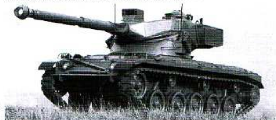
Seitens der Firma SDP wurde der Jagdpanzer "Kürassier" weiterentwickelt. Der Typ SK 105/A2 verfügt beispielsweise über eine Restlichtoptik, eine neue Mündungsbremse für das Verschießen von Pfeilmunition, über eine Feuerleitanlage sowie über ein Stabilisierungssystem für Kanone und Optik.
