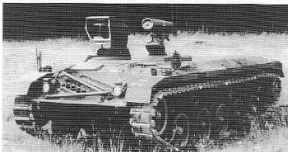
Prototyp eines Raketenjagdpanzers mit PAL 4000 auf dem Fahrgestell des Jagdpanzers "Kürassier".
